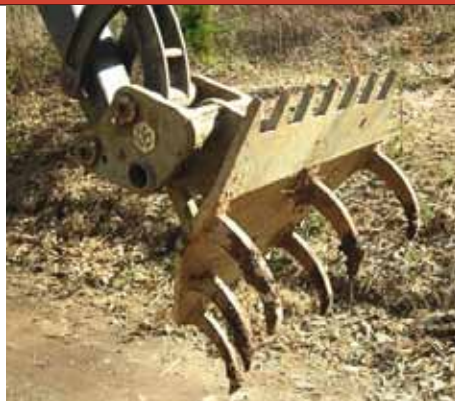
▲ De gauche à droite, pioche-herse (PH) et scarificateur réversible (SR). Ce sont les deux outils de désherbage mécanique testés sur minipelle.
