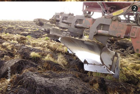
Technique 3B à la minipelle (1) et charrue à soc pour labour profond (30-60 cm) (2).
