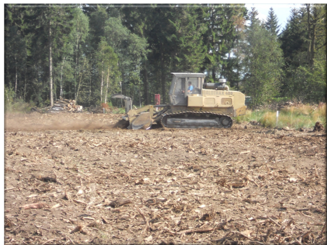
Broyeur lourd (300-400 ch) sur roue ou sur chenille
