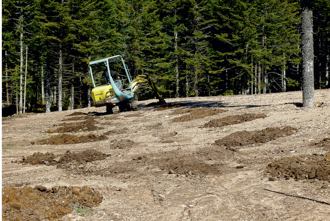
Ouverture de potets à la mini-pelle.
