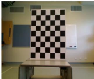
FIGURE – calibration d'une caméra
