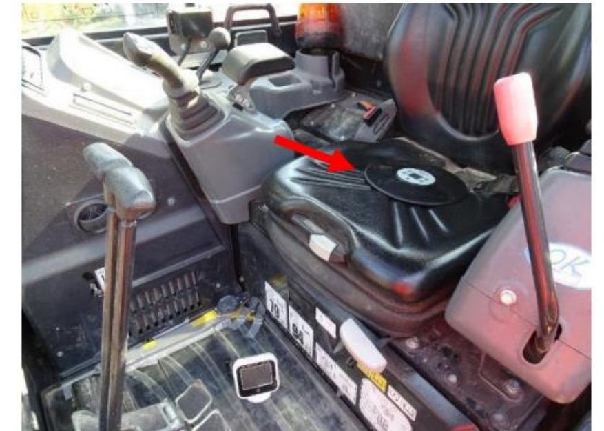
Figure 23 : Dosimètre de vibrations corps entier installé sur l'assise du fauteuil
