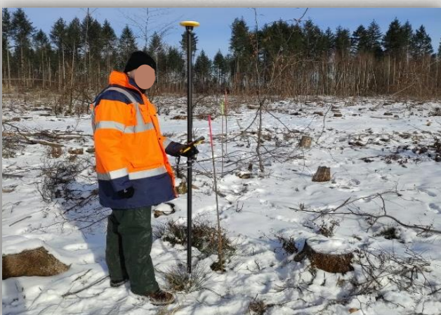
Etape 4 - Jalonnement au GPS
