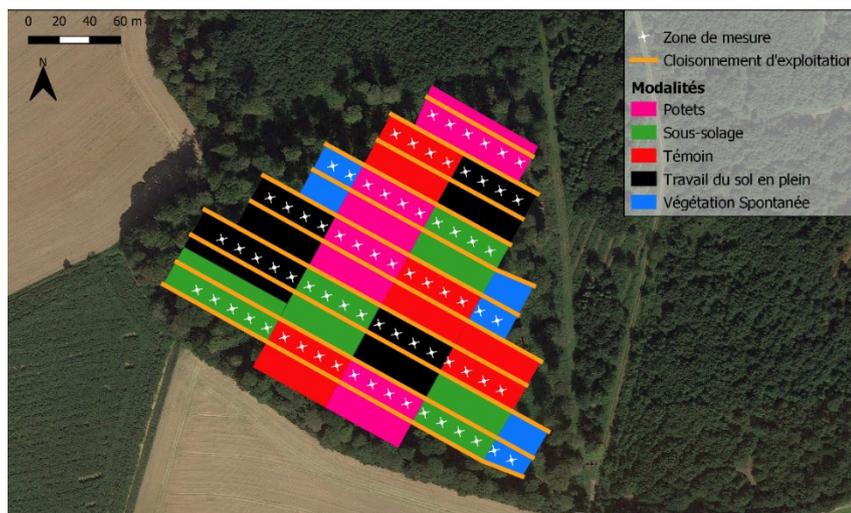
Figure 3 : Plan du dispositif représenté avec les différentes modalités et les points de mesures par UE de test-bêche et sondage PANDA®
