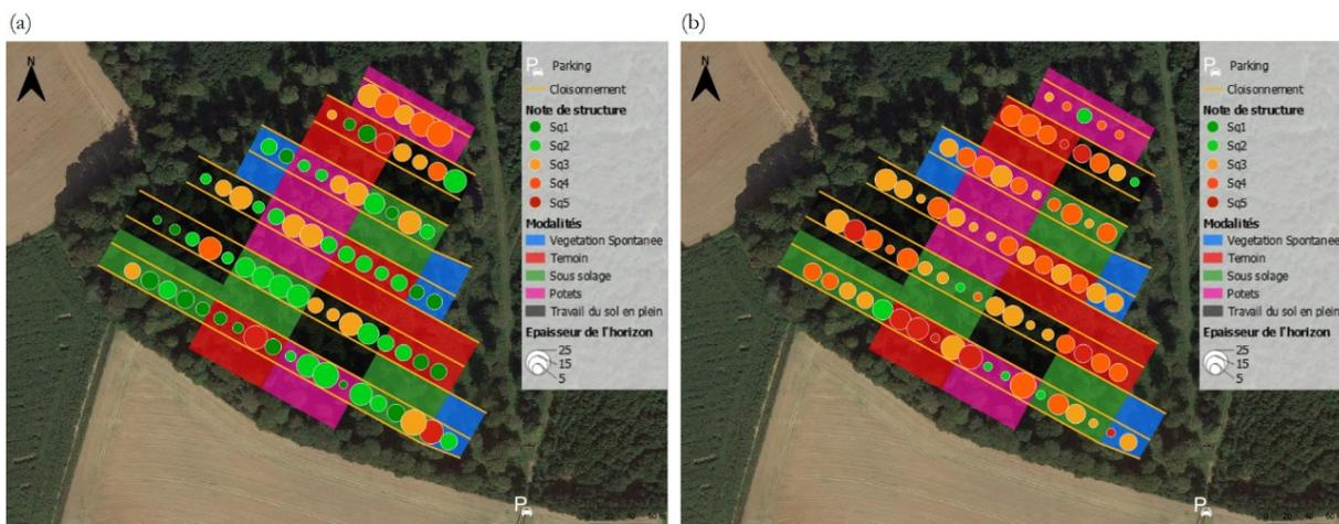
Figure 5 – Cartographie de l'état structural du sol après travaux de PMS sur l'horizon 1 (a) et l'horizon 2 (b)
