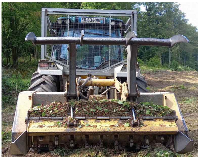
Fig. 10 Broyeur de la marque Plaisance avec rotor horizontal muni de marteaux.
