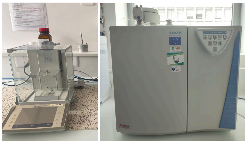
Fig. 13 De gauche à droite : balance de précision permettant de réaliser les pesées nécessaires avec passeur automatique et analyseur CHN.
