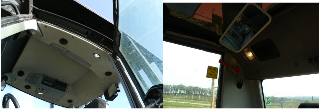
Lumière dans le poste de conduite du tracteur (à gauche) et de la pelle (à droite)
