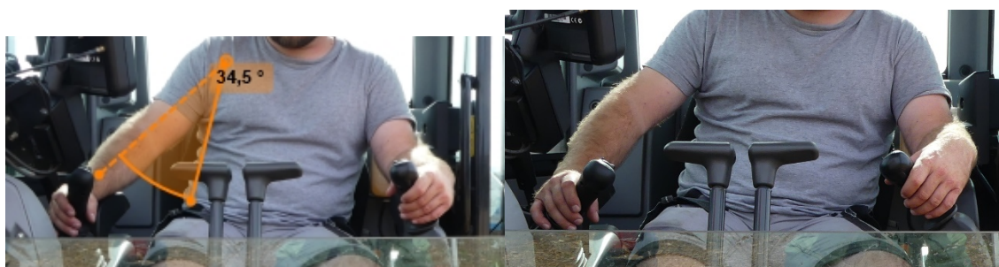
Position des bras lorsque les joysticks sont vers l'intérieur ou vers l'extérieur
