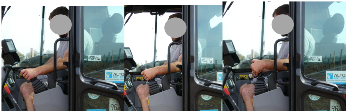
Position du bras gauche lorsque le joystick est avancé, neutre ou reculé
